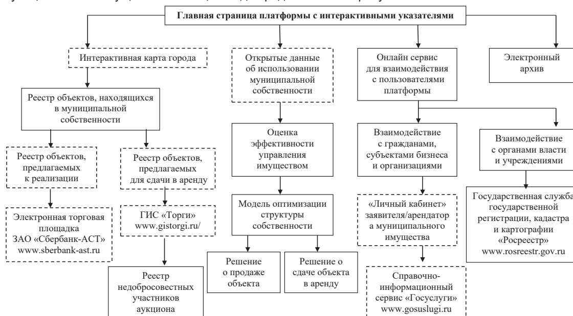
Рис. 1. Рекомендуемая схема функционирования цифровой платформы
