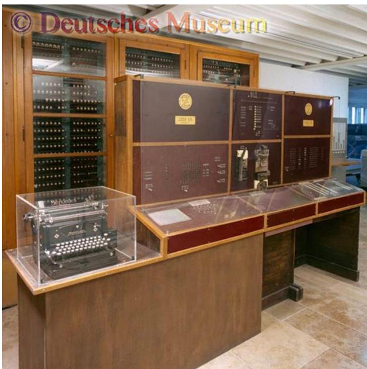
**Рисунок 1. Цифровая вычислительная машина Z4 Германа Цузе**
